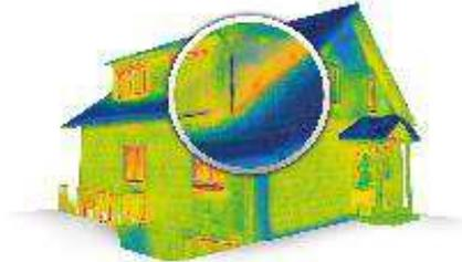
Luftundichtheiten führen neben Wohnkomfortmängeln und Wärmeverlusten auch zu bauphysikalischen Problemen wie z.B. Kondenswasserausfall in der Dämmung. Diese Undichtheit erzeugt aufsteigende Warmluft, die die Giebelseite erwärmt, was durch die orange-rote Farbe der Gaubenverkleidung sichtbar wird.
