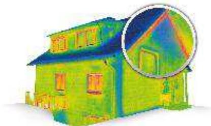
Eine typische Schwachstelle vieler Bestandsgebäude ist im Übergang der Fassade zum Dach zu finden. Im Thermogramm ist diese Wärmebrücke deutlich als roter Streifen zu erkennen.
