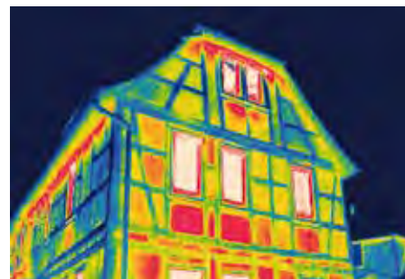
Abb. 22: Thermographieaufnahme eines Fachwerkhäuses. Das erkennbare Fachwerk wird bei der U-Wert-Berechnung flächenanteilig berücksichtigt.
