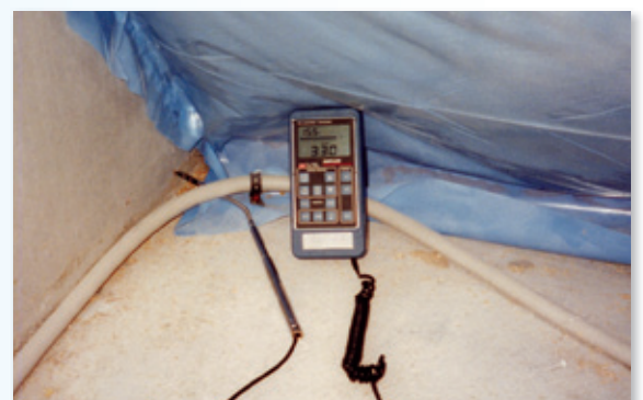
Leckageortung mit dem Anemometer
