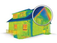
Eine typische Schwachstelle vieler Bestandsgebäude ist im Übergang der Fassade zum Dach zu finden. Im Thermogramm ist diese Wärmebrücke deutlich als roter Streifen zu erkennen.
