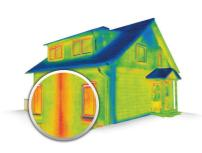
Einbindende Bauteile, wie hier eine Innenwand, die an eine Außenwand anschließt, stellen gravierende Wärmebrücken dar. Durch die große Oberfläche an der Innenseite verstärkt sich der Wärmefluss. Dies zeigt sich durch den senkrechten roten Bereich im Wärmebild.
