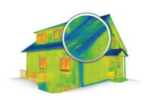
Dächer sind hinterlüftete Bauteile mit einem ungleichmäßigen Wärmedurchgang. Sie lassen sich von außen nur schlecht thermografieren, da sich Wärmebrücken durch die Luftschicht hinter den Dachziegeln nicht scharf abzeichnen. Hinzukommt, dass Außenthermogramme von Dächern häufig verfälscht werden, da aus dem Weltraum niedrige Temperaturen abstrahlen und Dachflächen kälter und somit blauer erscheinen, als sie wirklich sind.
