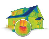
Auch in diesem Infrarotbild ist eine typische Wärmebrücke zu erkennen: die Heizkörpernische. An dieser Stelle ist das Mauerwerk häufig ausgespart, was neben der erhöhten Wärmezufuhr durch den Heizkörper dazu führt, dass in diesen Bereichen erhebliche Wärmedurchgänge zu verzeichnen sind. Im Thermogramm wird dies durch die rötliche Einfärbung unterhalb der Fenster deutlich.
